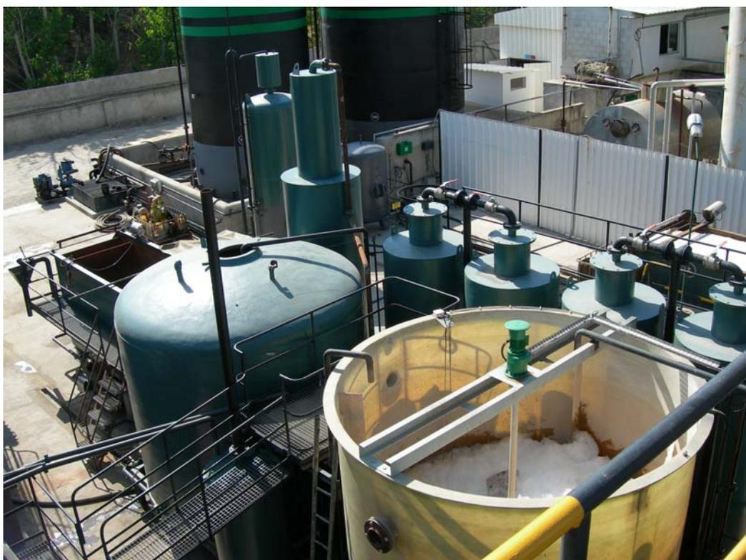
**Figura 4-6 - Tratamento efectuado às águas oleosas, emulsões e fluidos de corte (pormenor)**
