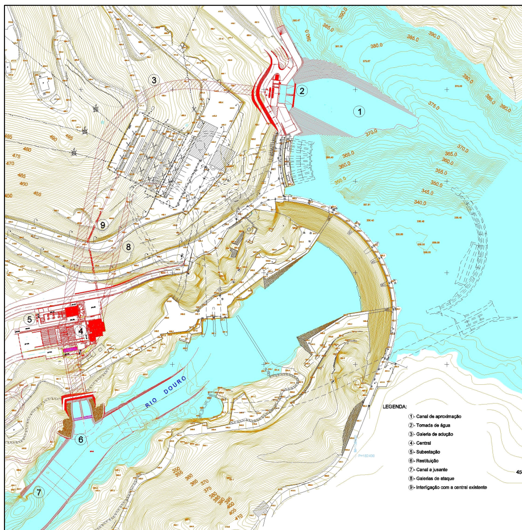
Figura 3 - Localização dos principais elementos do Reforço de Potência do Aproveitamento Hidroelétrico do Douro Internacional - Bemposta (a vermelho)
