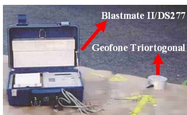
Figura 4.11.1 – Pormenor da instalação dos equipamentos de registo de vibrações
