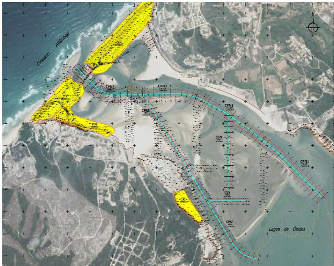
**Figura1** - Locais propostos para a deposição de dragados
