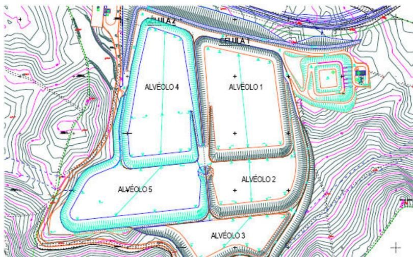
**Figura 3.1** - Células de deposição de resíduos no ASO.
