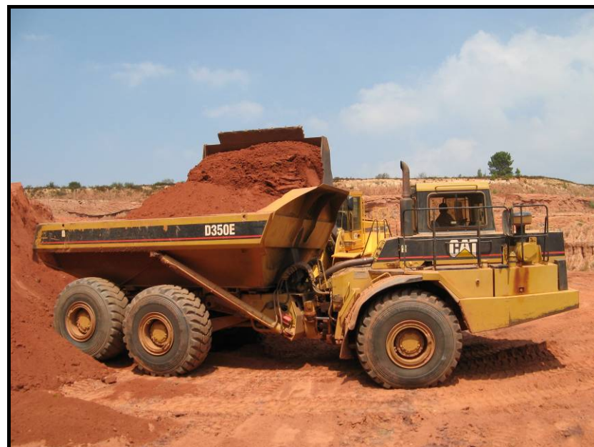
Fig. 2.4 - Carregamento do dumper pela pá carregadora
