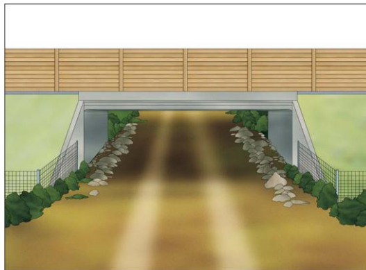
Figura 5.4 – Esquema ilustrativo de uma passagem inferior com barreiras visuais (Fonte: Iuell et al. , 2003).
