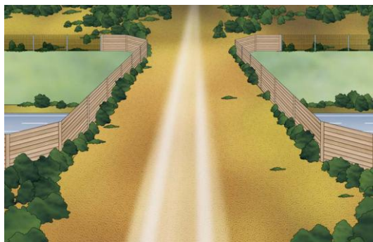
Figura 5.2 – Representação esquemática de uma passagem superior com barreiras visuais (Fonte: Ministerio de Medio Ambiente. 2006)
