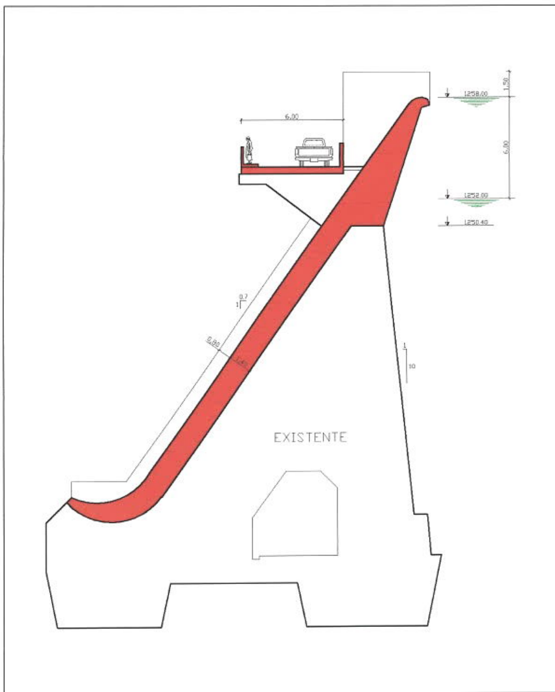
PERFIL TIPO DO DESCARREGADOR CORTE A-A
