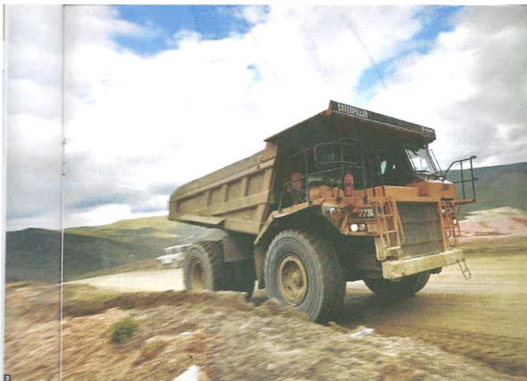
3. TRANSPORTE OS 'DUMPERS' SÃO RESPONSÁVEIS PELO TRANSPORTE DOS ESCOMBROS
