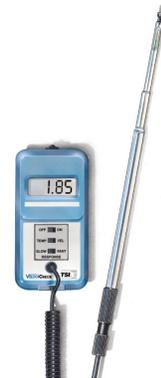
**Figura 3** – Ilustração do anemómetro *velocicheck* utilizado na avaliação das condições meteorológicas.
