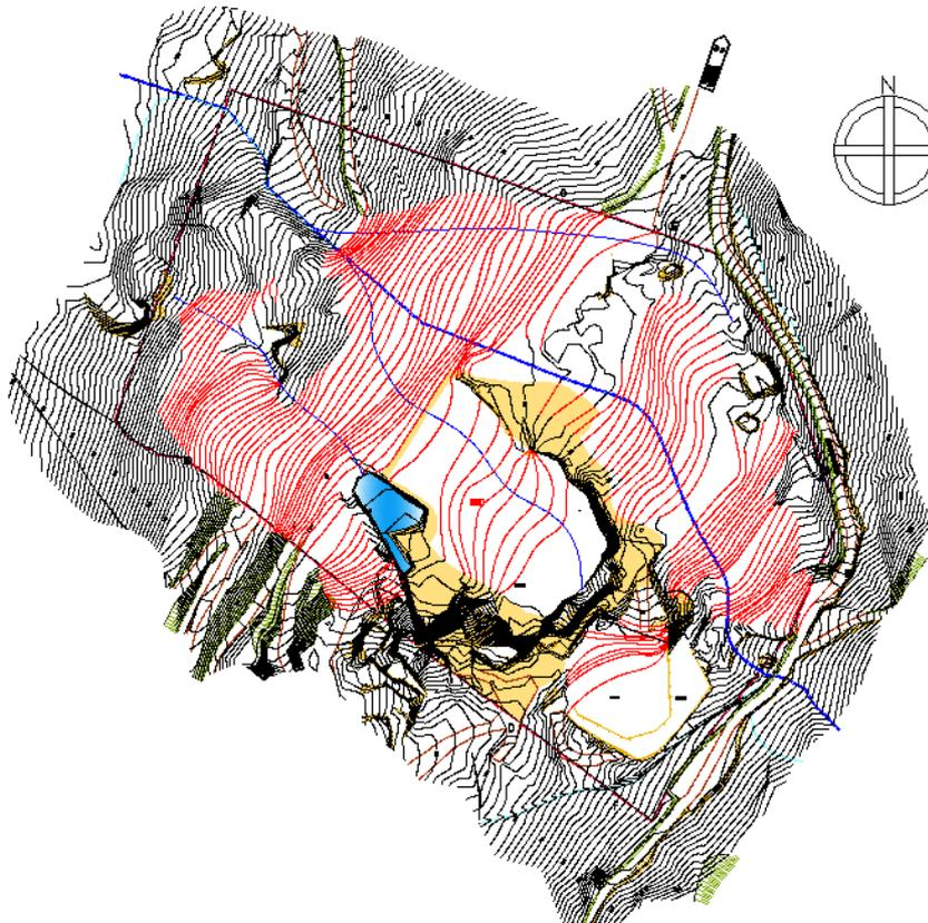
Figura 3.3.4. Sistema de drenagem proposto no final.
