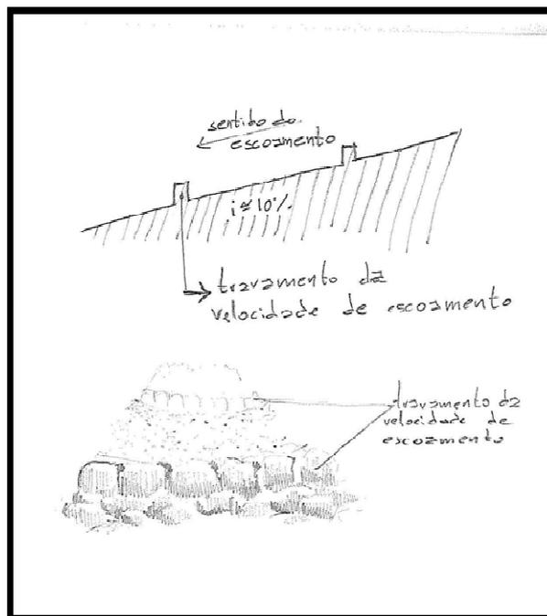
Figura 3.3.6. Esboços com a solução apresentada neste plano de recuperação.
