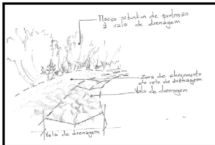
Figura 3.3.2. Enquadramento da vegetação com a linha de água, enfatizando uma zona de alargamento para caudais superiores aos suportados pela própria linha de água.
