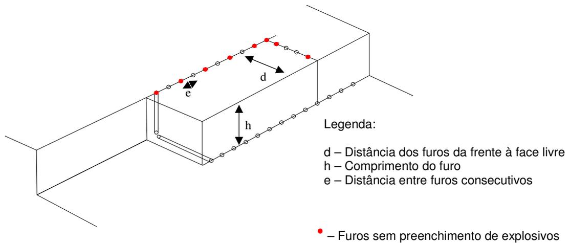
Figura 3.2.1. Representação esquemática do diagrama de fogo.
