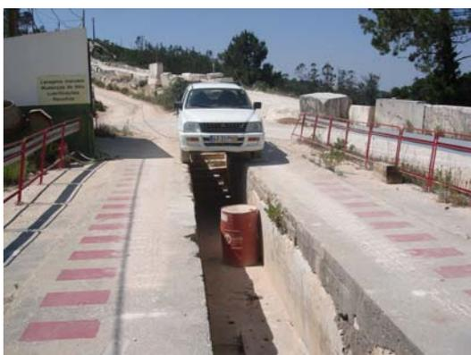
uma fossa de betão onde se procedem aos trabalhos de manutenção preventiva mais simples que se realizam aos equipamentos produtivos (óleos, lubrificantes, filtros, massas consistentes, baterias, etc.). As trocas de óleo usado por óleo novo realizam-se nas devidas condições de apetrechamento e impermeabilização exigidas para este tipo de trabalho mecânico. Como se visualiza, o local está devidamente sinalizado e apoiado lateralmente por barreiras de proteção.
