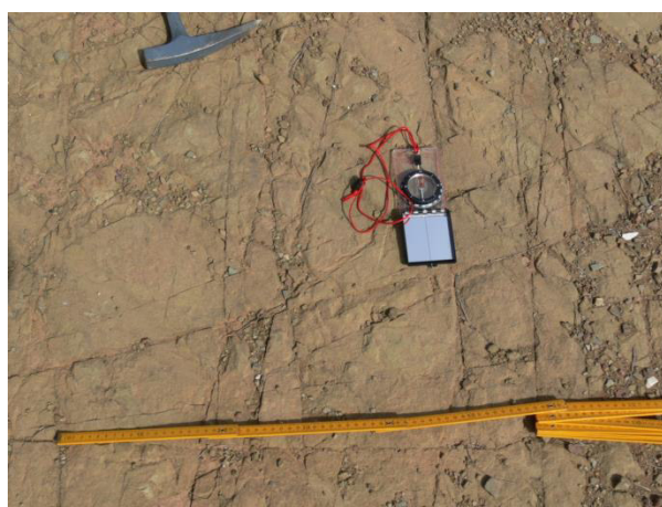
Fotografias 5.3 e 5.4 – Caminho no sector norte da área de estudo a cerca de 1 km a sul de Santa Justa. À direita observa-se o pormenor do afloramento rochoso no caminho e a densa rede de diaclasamento com direcções próximas de N-S (principal), N20°E; N70°E, com espaçamentos centimétricos e decamétricos (Local de amostragem A)
