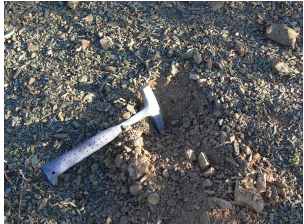
Fotografias 5.21 e 5.22 – Local previsto para a subestação (em 1º plano). À direita a camada superficial muito alterada, passando a medianamente alterada a cerca de 10 cm de profundidade (Local de amostragem J)
