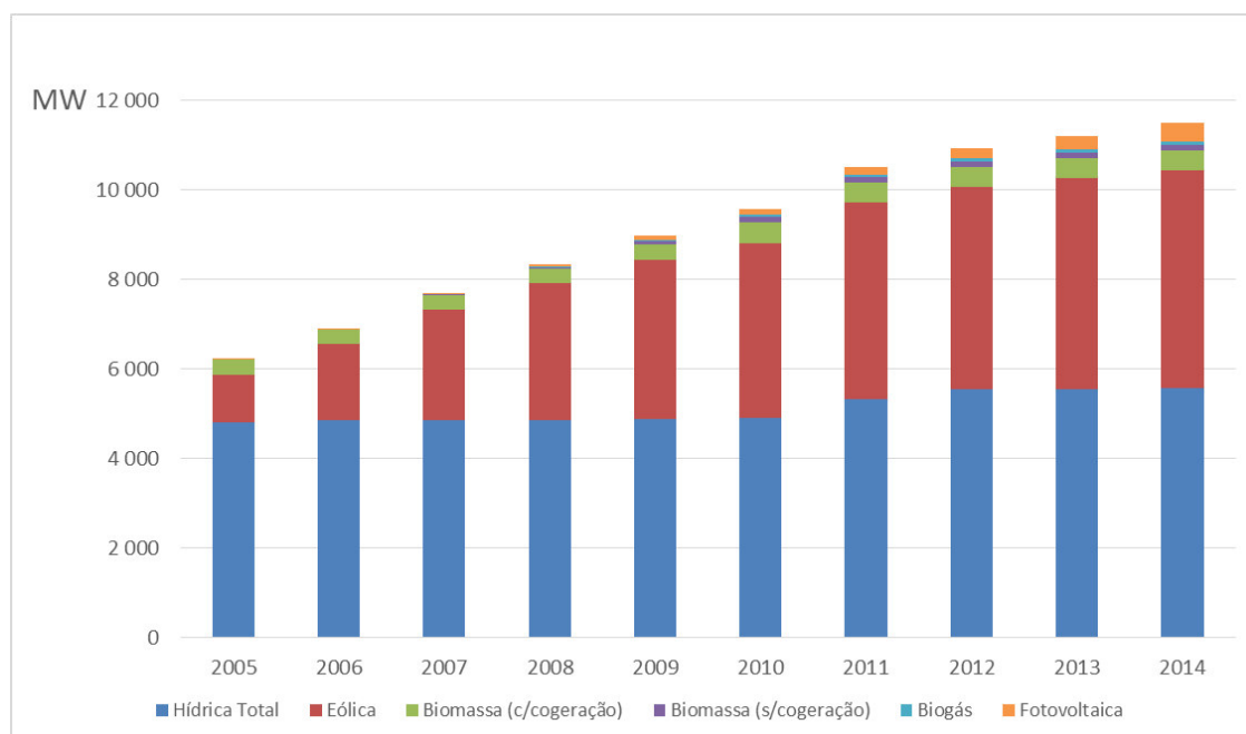
Figura 3.4 - Potência instalada em renováveis, entre 2005 e 2014 (www.dgeg.pt).
