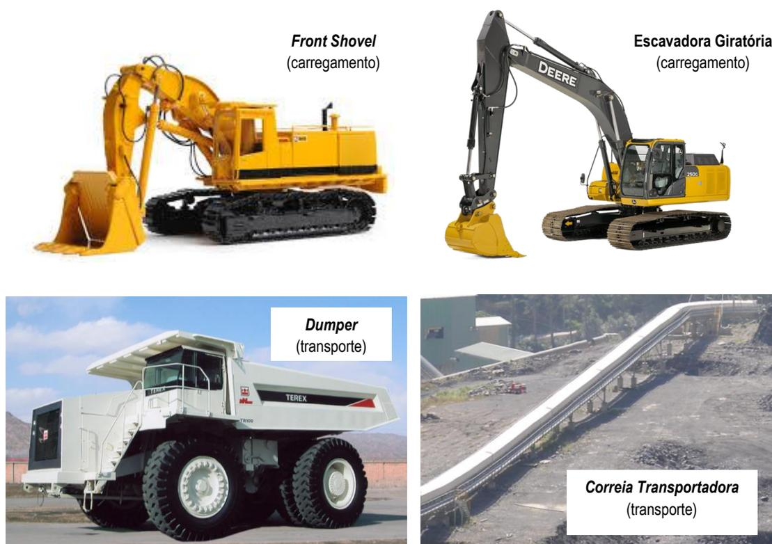
Figura II.28 – Imagens exemplificativas dos equipamentos a utilizar nas operações de remoção e transporte do minério.
