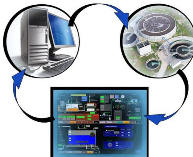
En este tipo de sistemas usualmente existe un ordenador, que efectúa tareas de supervisión y gestión de alarmas, así como tratamiento de datos y control de procesos. La comunicación se realiza mediante buses especiales o redes LAN. Todo esto se ejecuta normalmente en tiempo real, y están diseñados para dar al operador de planta la posibilidad de supervisar y controlar dichos procesos.
