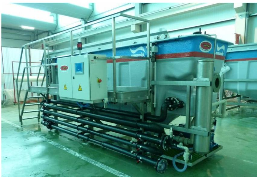
El agua bruta es mezclada con una corriente de agua reciclada desde el compartimento de salida. El agua ya tratada es recirculada a través de una bomba especial a un sistema de saturación de aire a 4 kg/cm<sup>2</sup> de presión. Por aplicación de
