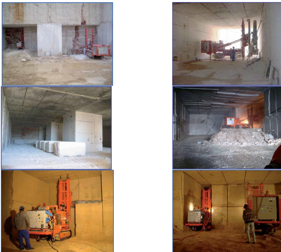
Figura 18- Sequência de imagens de algumas operações que compõem o método de desmonte da rocha em subterrâneo (Adaptado do catálogo da marca Fantini ).
