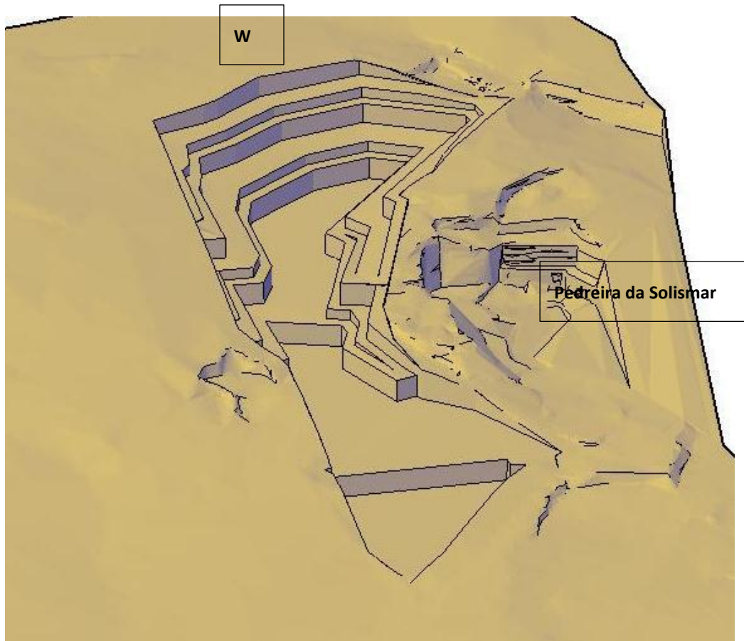
Figura 140 – Modelação 3D da corta da Pedreira da "Portela das Salgueiras" na qual também é possível observar a corta da pedra da Solismar bem como a frente antiga a sul.
