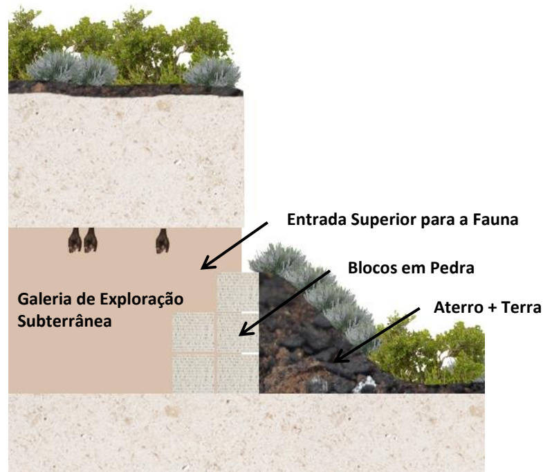
Figura 22. Esquema de encerramento das entradas para a galeria subterrânea, originada pela exploração.
