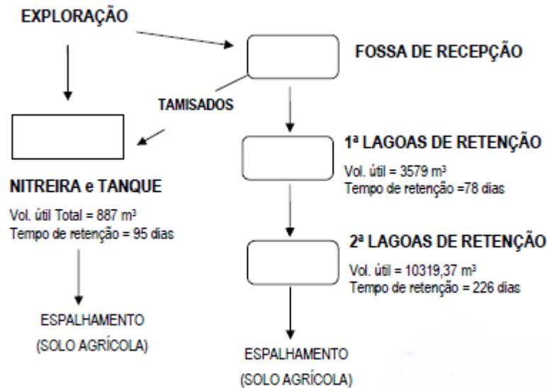
Figura 24 - Diagrama do sistema de tratamento implantado
