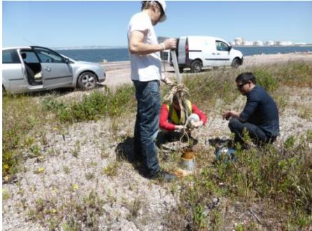
Figura 9 – Amostragem de água subterrânea através de um piezômetro instalado no parque empresarial do Barreiro
