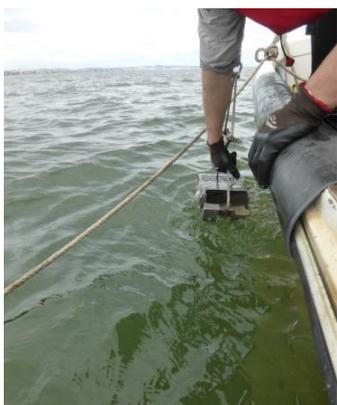
*Figura 11 – Amostragem de sedimentos superficiais*
