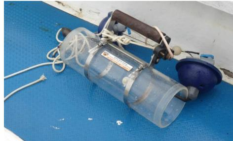
Figura 10 – Garrafa amostradora usada na campanha de amostragem da qualidade da água do rio Tejo, na zona do Barreiro/Lavradio
