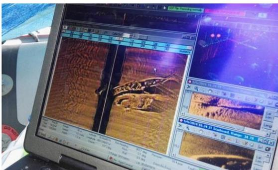
Figura 15 – Momento de deteção de anomalia no fundo, através de métodos geofísicos
