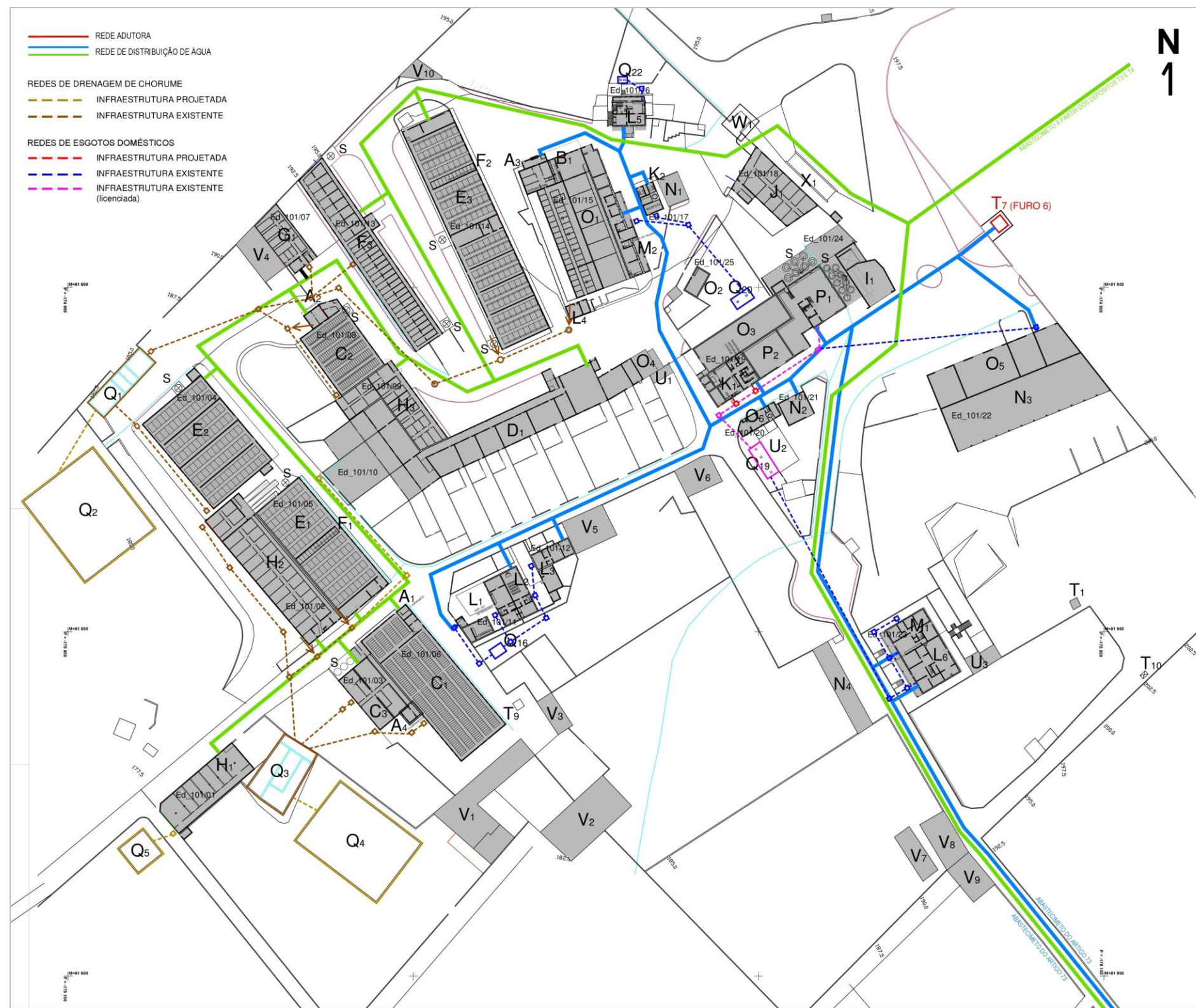
Figura 6 - Rede de drenagem de efluentes pecuários dos pavilhões situados na zona mais central da Herdade da Tapada
