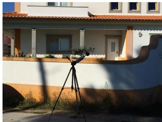
**Figura 5.38** – PM 02 - Ponto de medição de ruído a 330 metros do limite sul da propriedade
