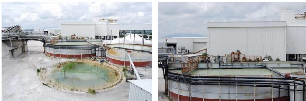
Tanques de decantação e homogeneização do caulino
