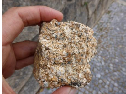
Figura 31 – Granito do Porto (amostra de mão, já com evidências de alteração, recolhida em talude próximo do Porto de Leixões)
