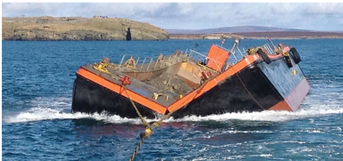
Figura 26 – Exemplo de um batelão do tipo split durante uma operação de descarga de enrocamentos
