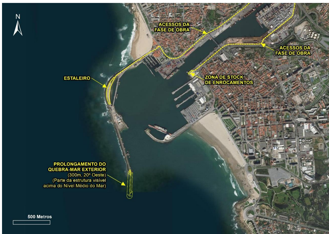
Figura 22 – Prolongamento do quebra-mar exterior: implantação, acessos e áreas de apoio à construção
