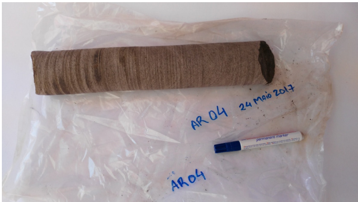
Fig.32 – Carote AR04, carote de rocha cristalina cinzenta, muito coerente.
