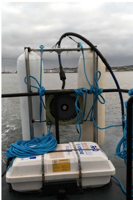
Fig. 7 – Catamaran com a placa de boomer ao centro, preso a balastrada de popa, durante os trânsitos sem aquisição de dados de sísmica.
