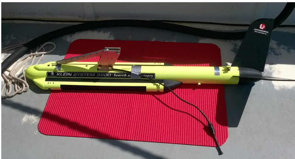
Fig.4 – “peixe” transdutor do sistema sonar lateral usado nos trabalhos.
