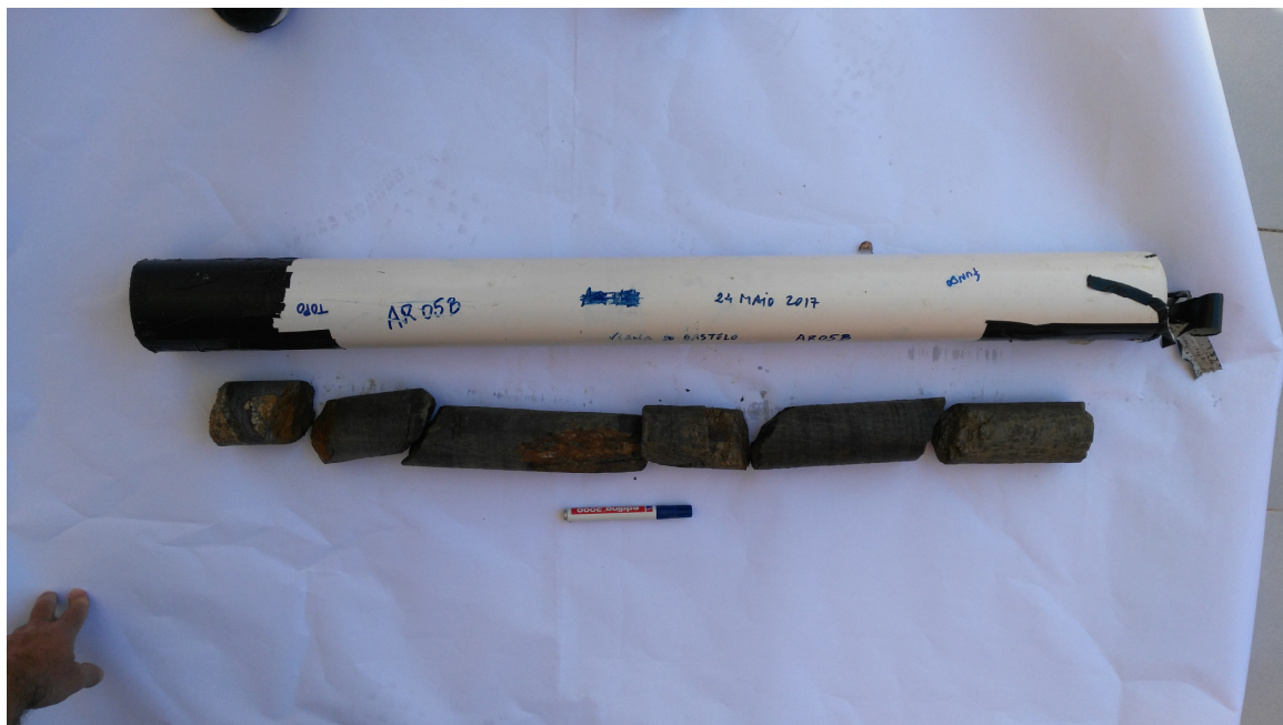
Fig.35 – Carote AR05B, colhido um xisto-grauvaque, duro, com 90cm de comprimento..
