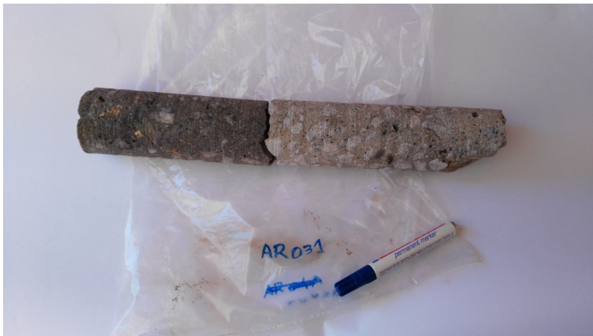
Fig.33 – Carote AR031, carote de rocha material que revelou tratar-se de betão..
