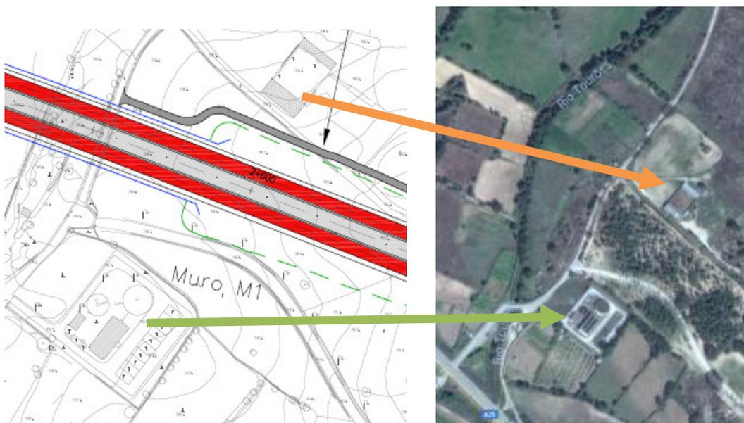
Extrato de planta do traçado cerca do Pk 2+550 zona da ETAR e edificação existentes
