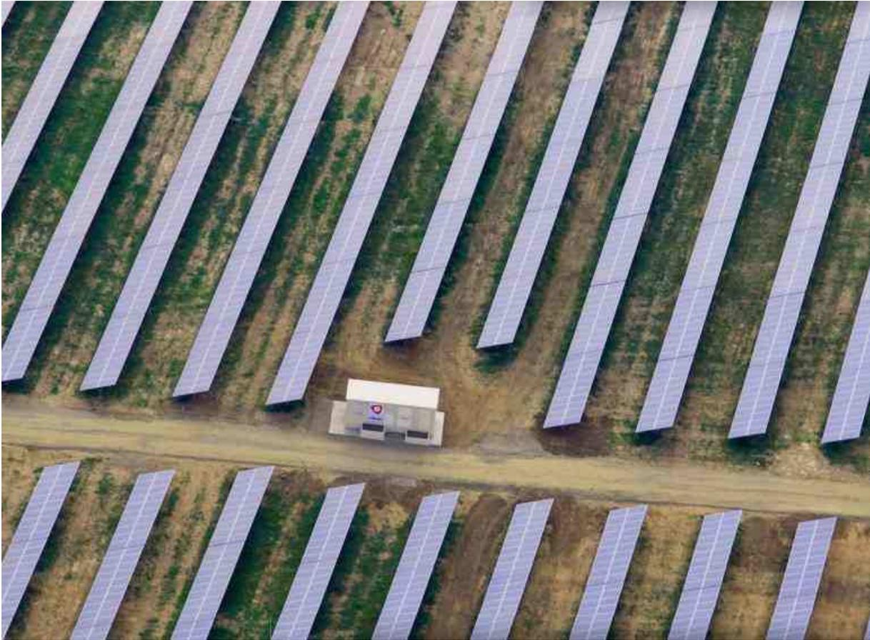
Figura 5 – Exemplo de localização do tipo de infraestrutura que contém o inversor/transformador (Fonte: Efacec).
