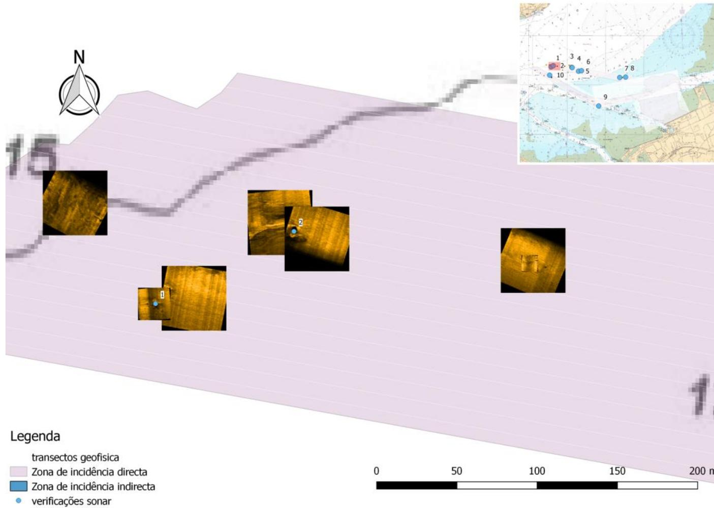
*Figura 340 – Anomalias detetadas por sonar de varrimento lateral SVL1 e SVL 2*
