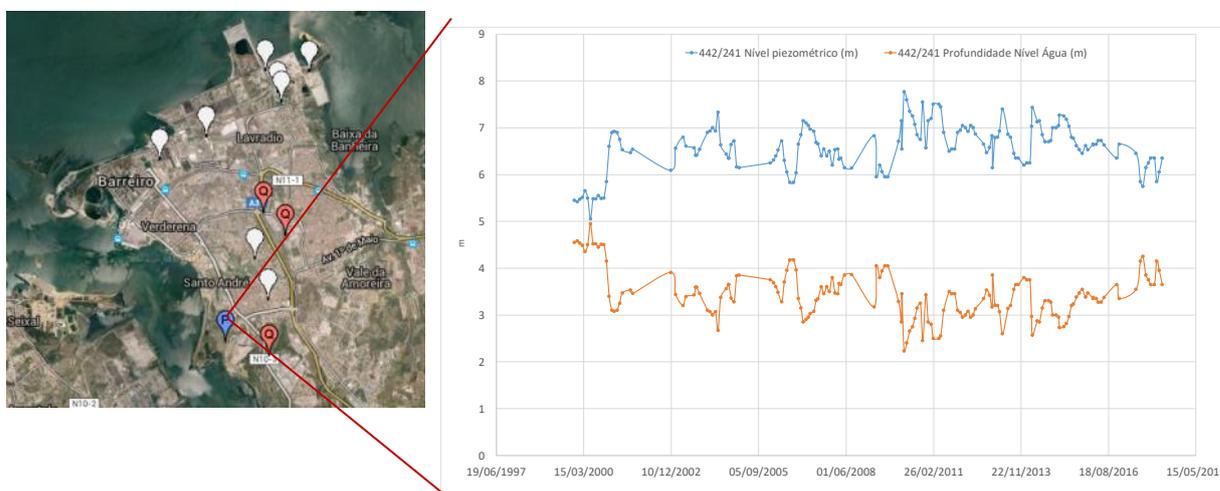
Figura 179 – Oscilação do nível piezométrico do poço 442/241
