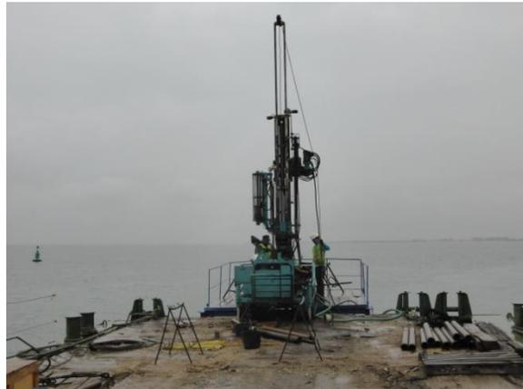
Figura 224 – Amostragem de sedimentos em profundidade
