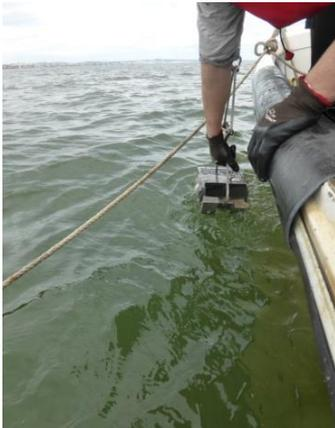
Figura 223 – Amostragem de sedimentos superficiais
