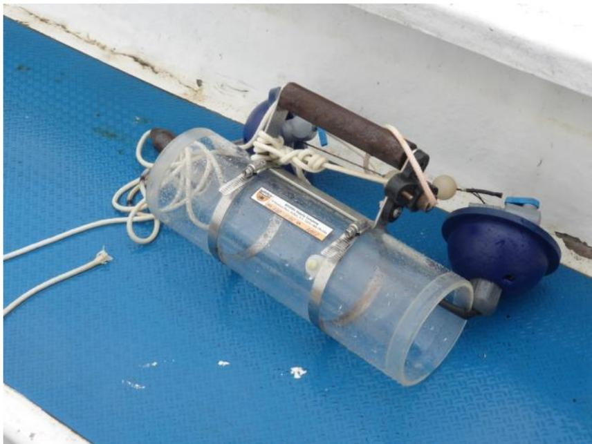
Figura 214 – Garrafa amostradora vertical em acrílico (ALPHA WATER SAMPLER) utilizada na campanha de amostragem da qualidade da água
