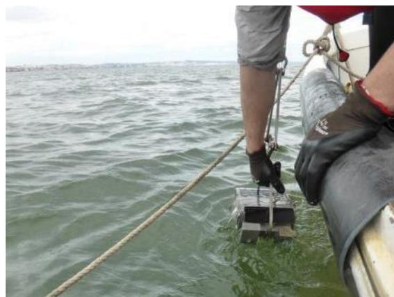
*Figura 267 – Prospecção de macroalgas em águas profundas e sem visibilidade – lançamento de Petite Ponar em 15 estações de amostragem*
