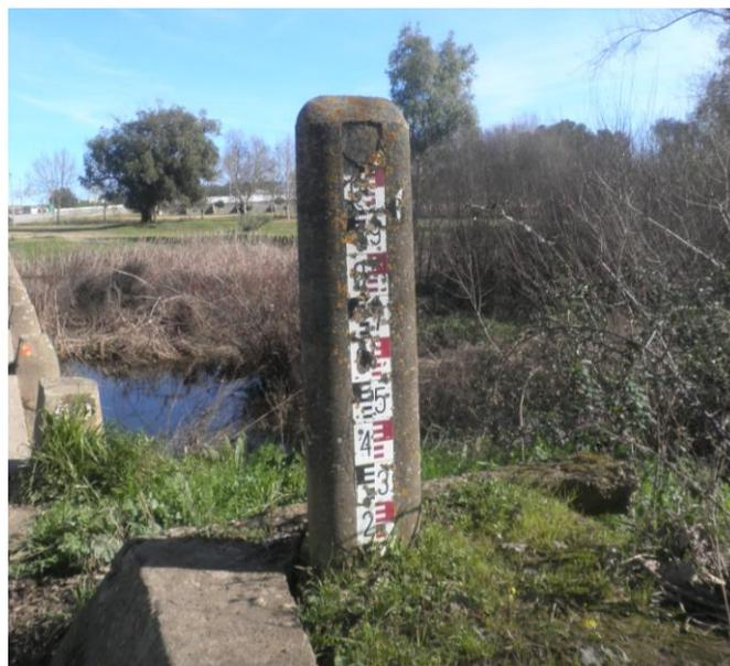
**Figura 25 – Fotografia - Escala hidrométrica junto da ponte sobre o rio Xévora, a entrada da Herdade da Enxara.**
