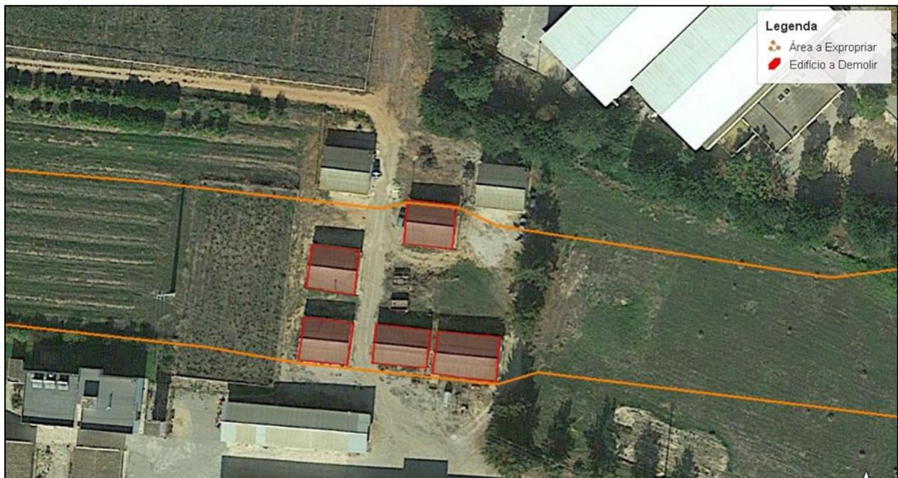
Figura 7 – Cinco edifícios (pré-fabricados) a demolir para o restabelecimento da PN 371+317
