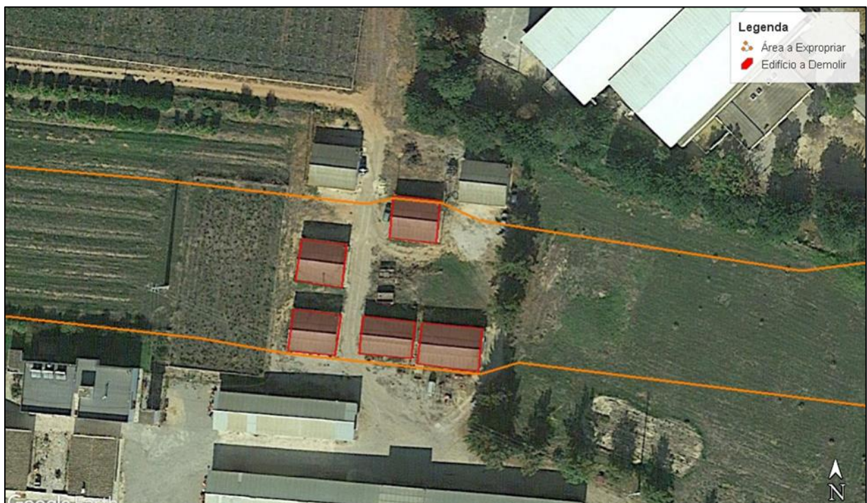
Figura 12 – Cinco edifícios (pré-fabricados) a demolir para o restabelecimento da PN 371+317
