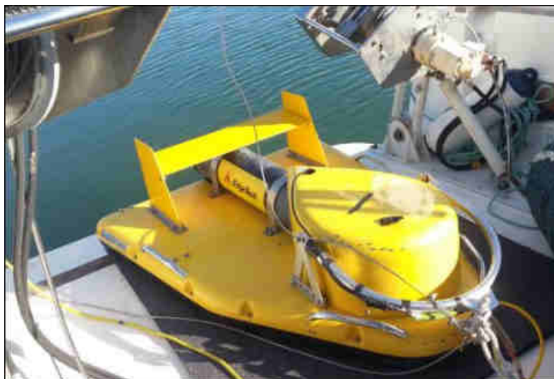
Figura.18. Sistema combinado de Chirp/Sónar (0,5-12kHz) y sónar de barrido lateral de doble frecuencia (100kHz y 400kHz), modelo Edgetech 512i
