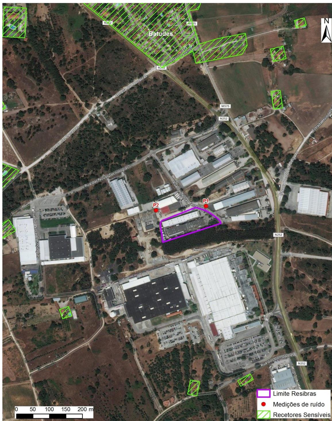
**Figura 5.46-** Identificação das fontes sonoras (via rodoviária EN252 e unidades industriais), recetores sensíveis (Batude) e localização dos pontos de medição de ruído na envolvente da Resibras.
