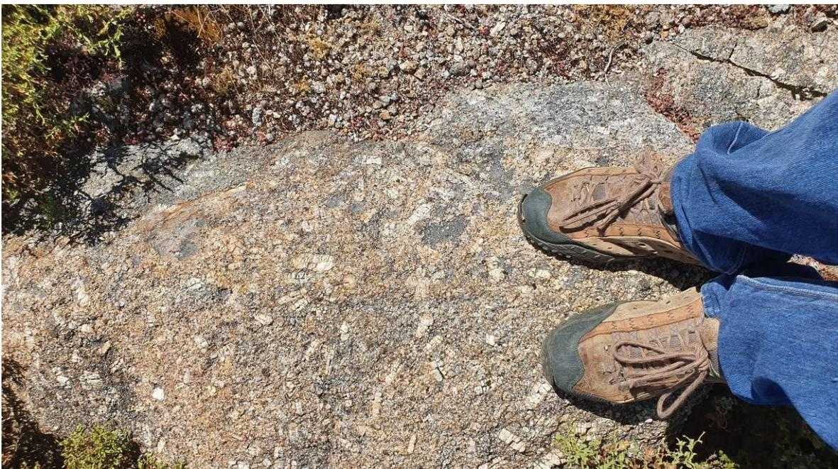
Figura 4 – Aspecto do maciço granítico aflorante medianamente alterado
