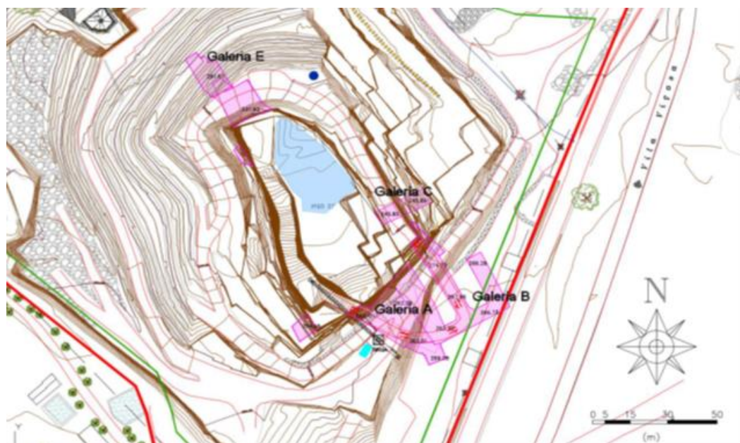
Figura 2 - Identificação das principais galerias subterrâneas existentes
