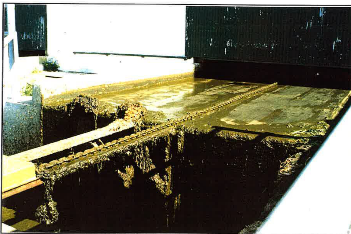
Figura A3.5 Aspecto do sistema mecânico de limpeza do estrume - lançamento na vala
