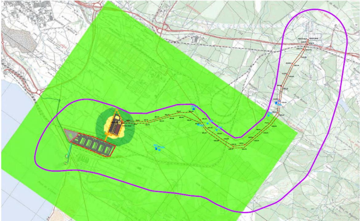
Figura 9. Mapa de ruído previsual associado ao funcionamento do Data Center, com os geradores de emergência em operação, na fase de exploração, para o indicador Lden (imagem superior) e Ln (imagem inferior).
