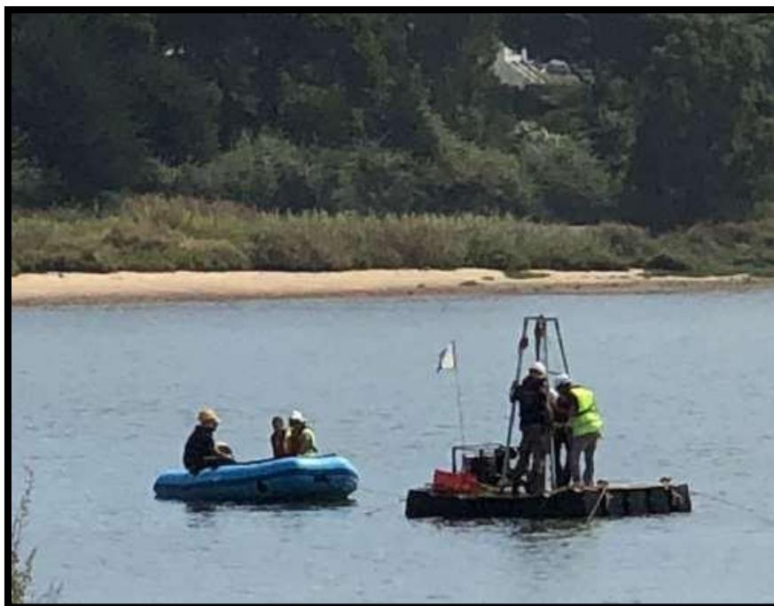
Figura 4 – Recolha core das amostras de sedimentos
