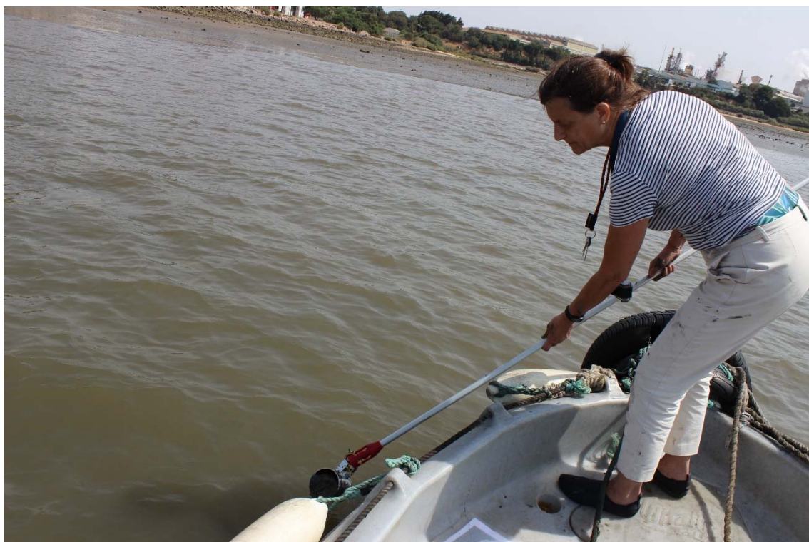
Figura 14- Procedimento de recolha de sedimentos superficiais, com recurso a crivo, na área de maior profundidade, à entrada da caldeira.
