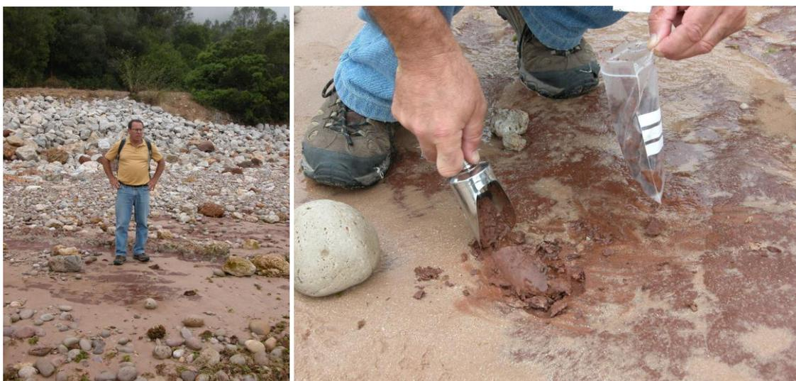
Figura 7 – Bancada argilosa, localizada na zona intertidal, sujeita à acção erosiva das ondas e correntes (imagem da esquerda); Pormenor da unidade argilosa sujeita à erosão marinha (imagem da direita).
