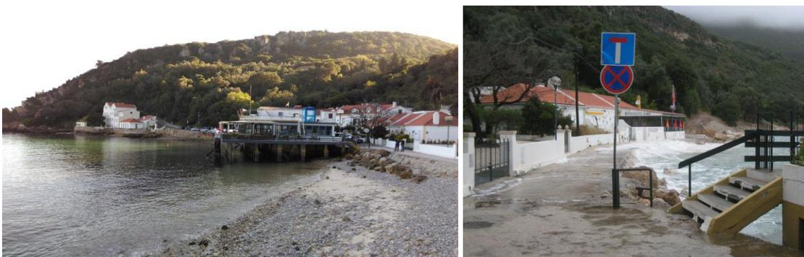
Figura 14 – Caminho de acesso ao restaurante o farol. Na preia-mar o mar atinge a base da estrutura de protecção e, durante os temporais, é comum a água galgar a infra-estrutura, pondo em causa a integridade da mesma e das construções aí existentes. De notar que o restaurante Galeão (na imagem da esquerda), que nos anos cinquenta se encontrava construído sobre areia de praia, se encontra hoje sobre estacas devido ao recuo da linha de costa verificado no Portinho.
