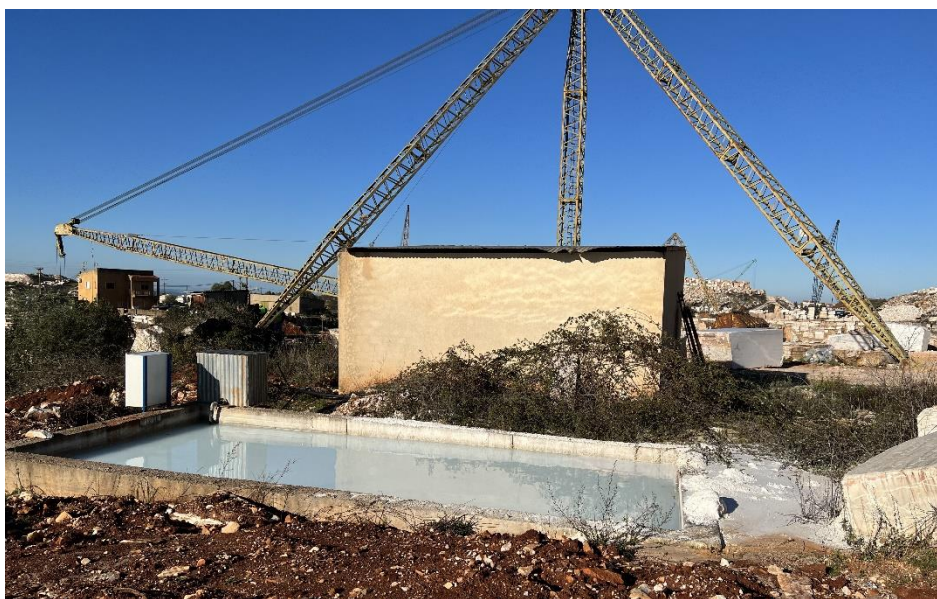
Figura 62. Tanques de decantação associados à monolâmina.
