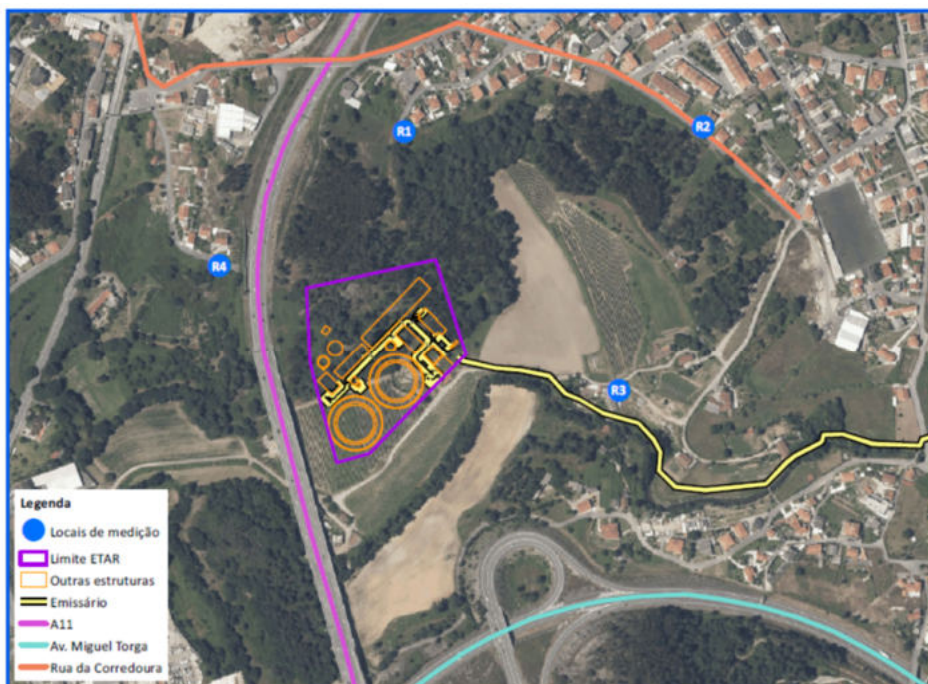
Figura 5: Identificação dos pontos de medição junto dos recetores sensíveis mais próximos na envolvente da ETAR do Este. Fonte: adaptado do RS do EIA, 2023.
