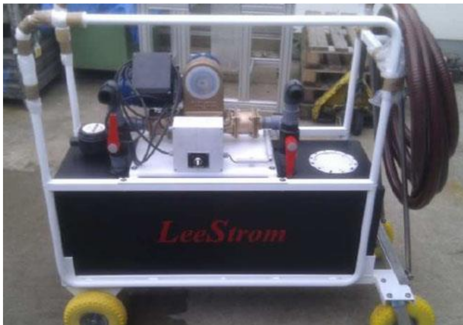
Fotografia 9 – Depósito móvel para remoção das águas residuais utilizado no Porto do Recreio de Olhão.
