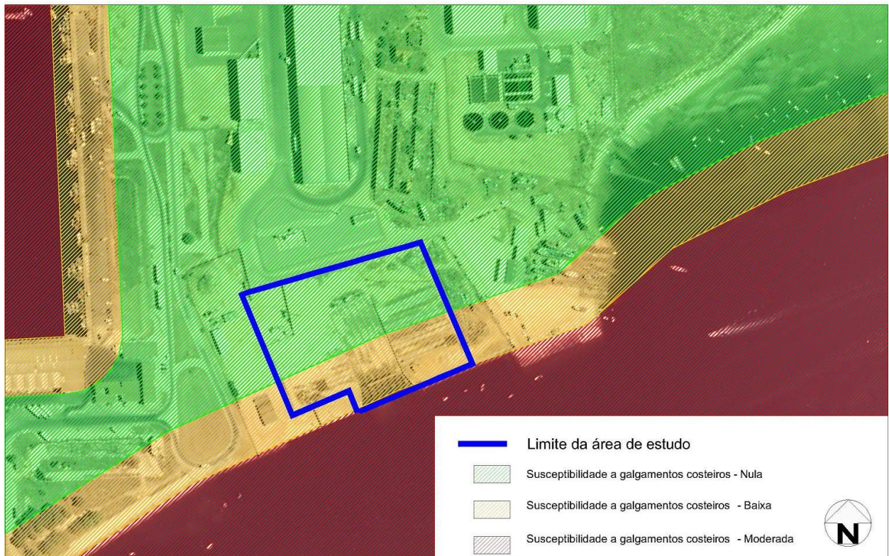
Figura 13 – Risco de galgamento costeiro.
