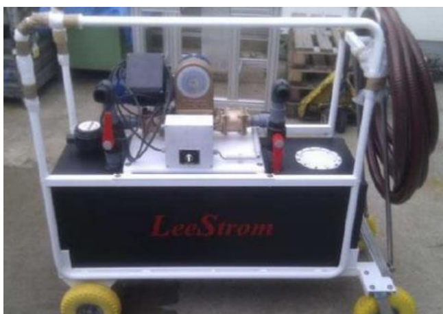
Figura 9. Exemplo de dispositivo móvel para recolha das águas residuais das embarcações. (Fonte: parecer setorial da APA/ARH Algarve, fevereiro de 2024)
