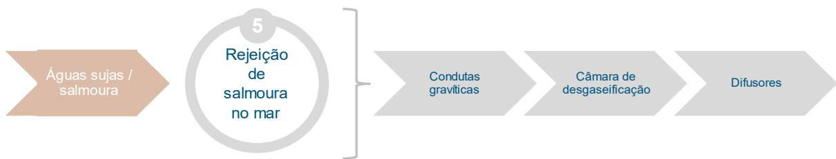
**Figura 4.18 – Esquemática dos processos envolvidos na descarga de salmoura no mar.**
