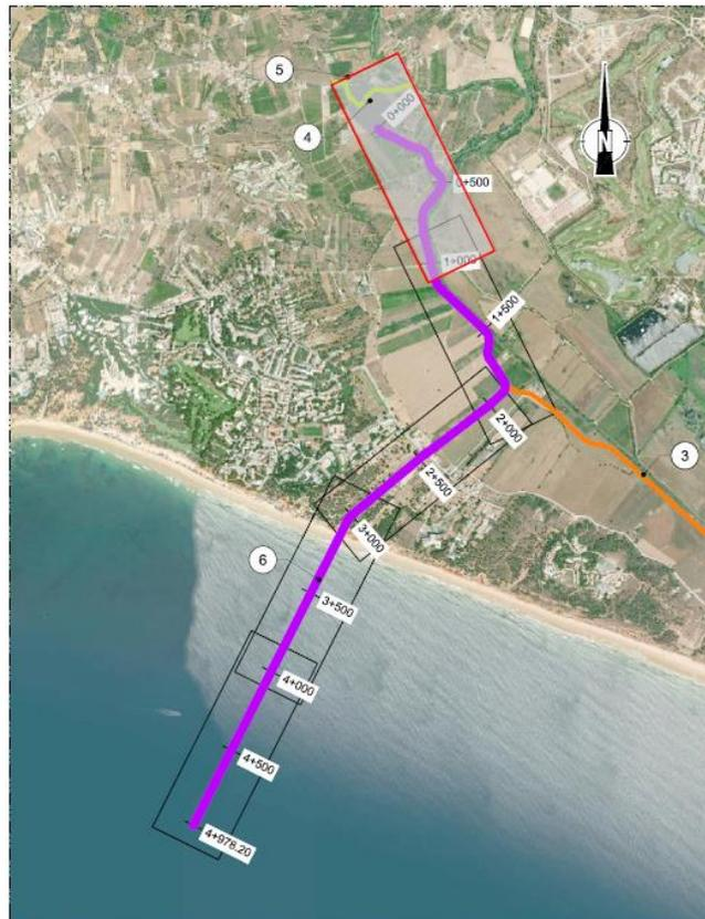
Figura 4.19 – Visão geral do local de implantação da conduta de rejeição da salmoura da Alternativa 1 (linha roxa).
