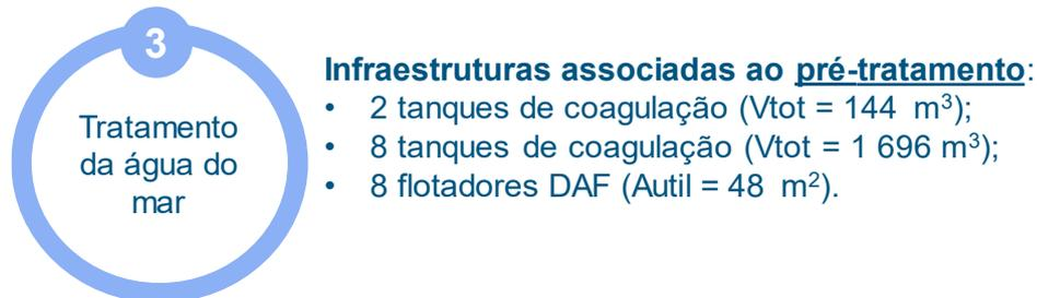
**Figura 4.13 – Esquemática das infraestruturas associadas ao processo de pré-tratamento da água do mar.**
