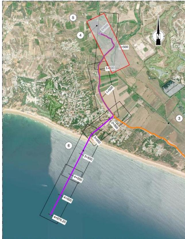
**Figura 4.20 – Visão geral do local de implantação da conduta de rejeição da salmoura da Alternativa 2 (linha roxa).**
