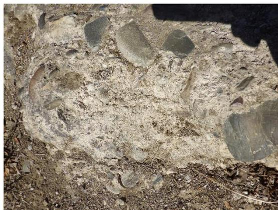
**Figura 35 –Pormenor da fratura do *opus cimenticium* (2)**
