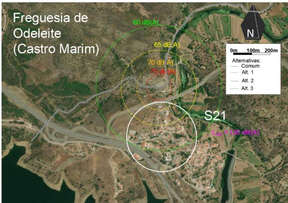
Figura 18 - Mapa de Ruído na fase de construção junto à Situação S21 (Alternativa 1, 2 e 3) para uma fonte pontual com  $L_{Aw} = 120 \text{ dB(A)}$
