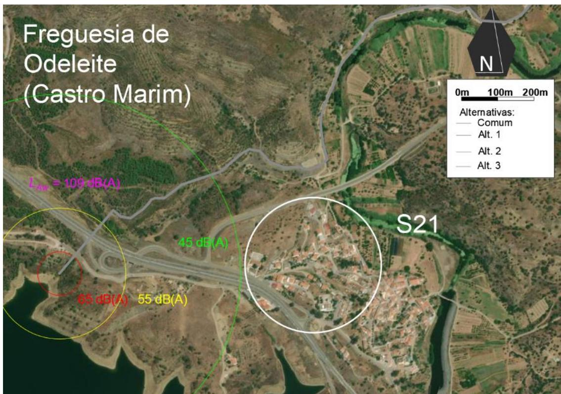
Figura 20 - Mapa de Ruído na fase de exploração junto à Situação S21 para uma fonte pontual com  $L_{Aw} = 109 \text{ dB(A)}$
