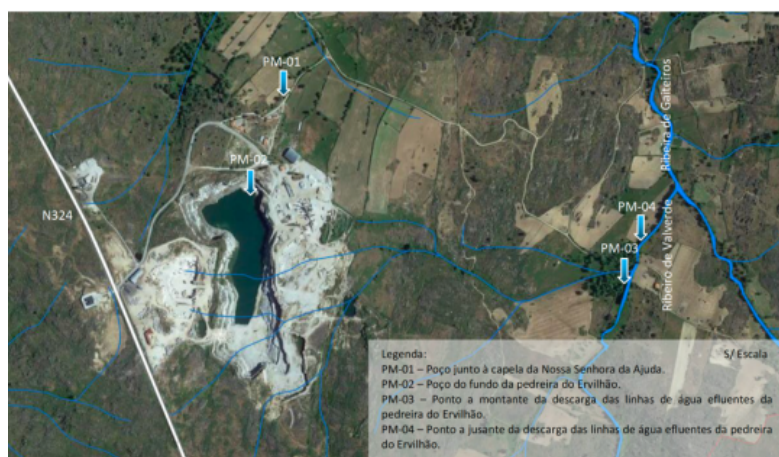
Figura 1 - Locais dos pontos de amostragem dos Planos de Monitorização dos Recursos Hídricos
