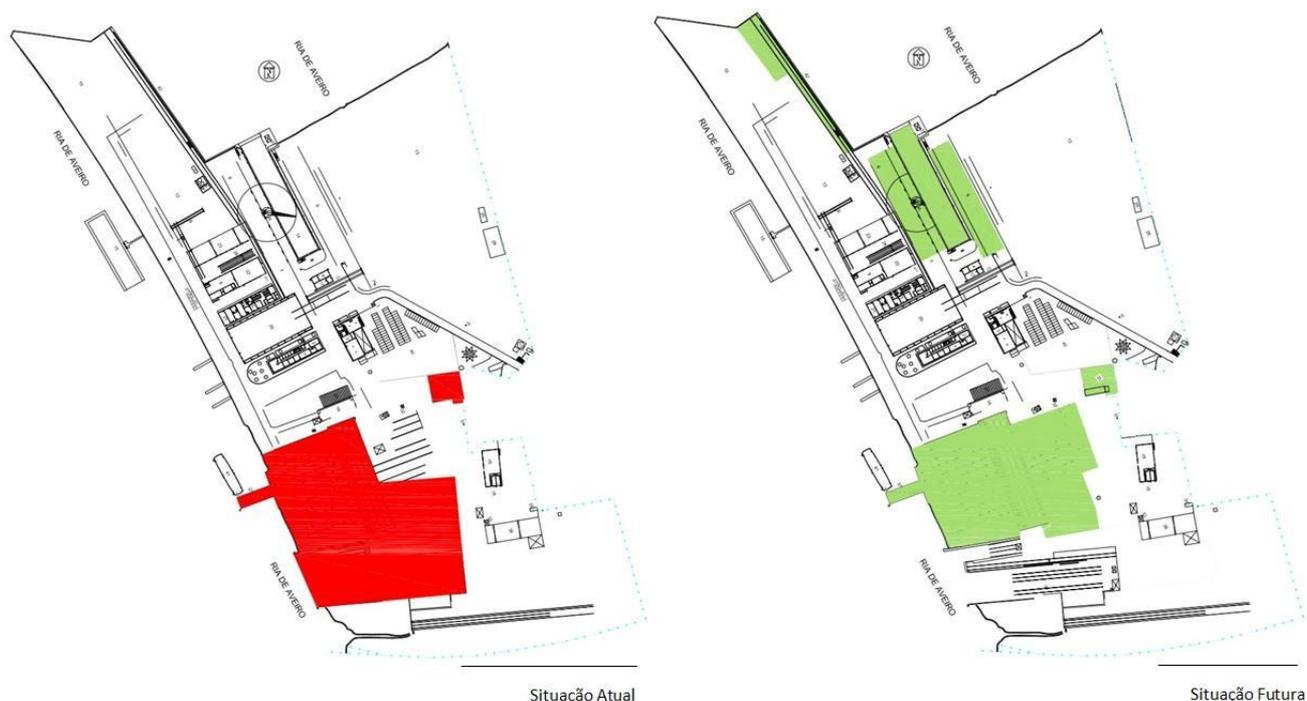
**Figura 3.1** – Layout da Navalria, S.A – Unidade de Reciclagem de Navios – infraestruturas/áreas licenciadas pelo Alvará n.º05/2015/CCDRC (a cor vermelha) e infraestruturas a licenciar no âmbito do presente projeto (a cor verde).
