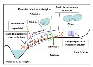
Figura 2: Transporte e atenuação de contaminantes.
