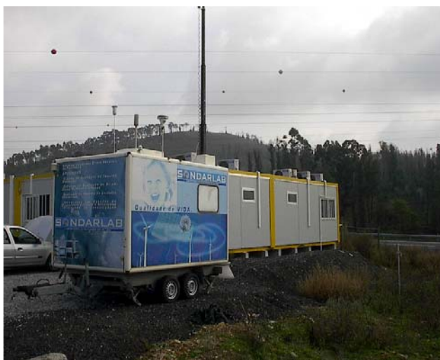
Figura 3 – Perspectiva da estação móvel de qualidade do ar durante as medições realizadas em P1 – IC24 (A41) Alfena.
