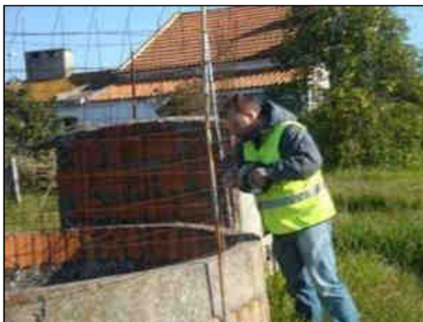
Fotografia 24 – Medição de coluna seca com recurso a sonda portátil
