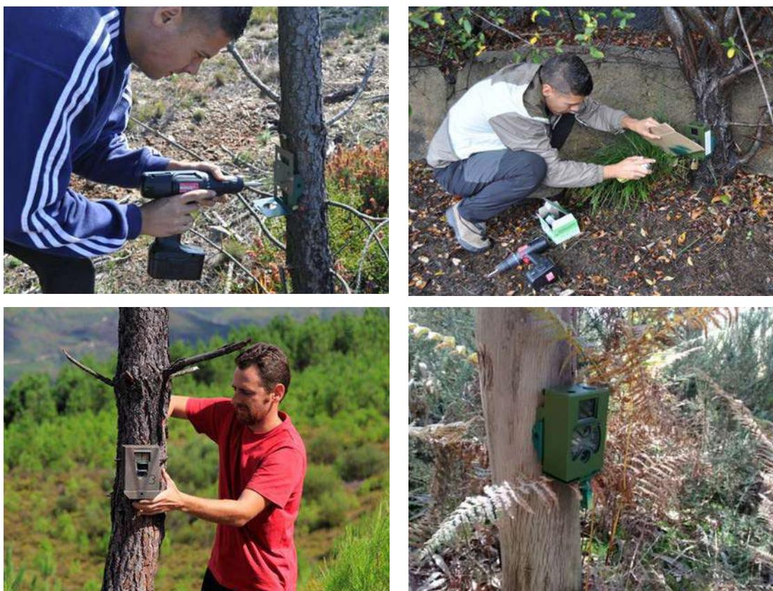
**Figura 2.** Processo de instalação de uma câmara de fotoarmadilhagem.
