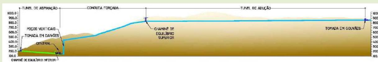
Figura 3: Circuito hidráulico de Gouvães
